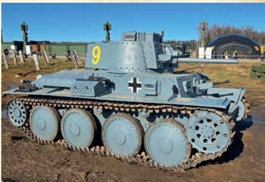
НЕМЕЦКИЙ ЛЕГКИЙ ТАНК Pz.Kpfw.38(t) ЧЕХОСЛОВАЦКОГО ПРОИЗВОДСТВА С ПУШКОЙ «ШКОДА» КАЛИБРОМ 37 ММ И БРОНЕЛИСТАМИ 8-25 ММ
