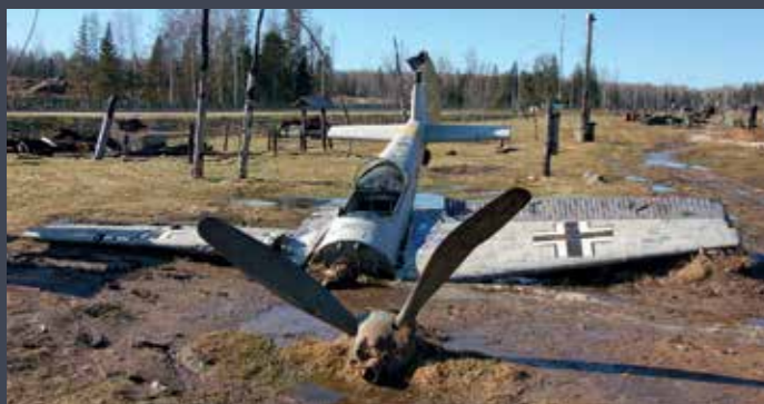
ИСТРЕБИТЕЛЬ «МЕССЕРШМИТТ ВФ 109», САМЫЙ МАССОВЫЙ САМОЛЕТ ЛЮФТВАФЕ. БЕНЗИНОВЫЙ ПОРШНЕВОЙ ДВИГАТЕЛЬ DAIMLER-BENZ DB 601 V 12, 2 КУРСОВЫХ ПУЛЕМЕТА 7,92 ММ, 2 ПУШКИ 20 ММ В КРЫЛЬЯХ, БРОНЕСТЕКЛО КАБИНЫ 58 ММ
