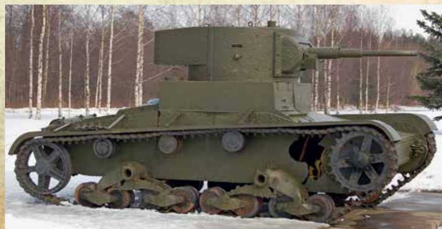
СОВЕТСКИЙ ТАНК Т-26, РЕПЛИКА АНГЛИЙСКОГО VICKERS MK E. БАШЕННОЕ ОРУДИЕ КАЛИБРА 45 ММ, БРОНИРОВАНИЕ 6–15 ММ
