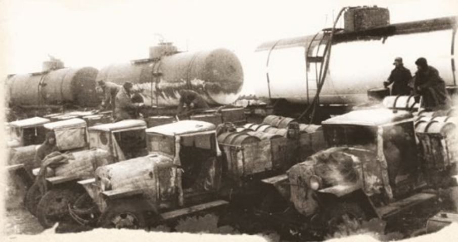
Перевалка топлива с железнодорожного транспорта на автомобильный
